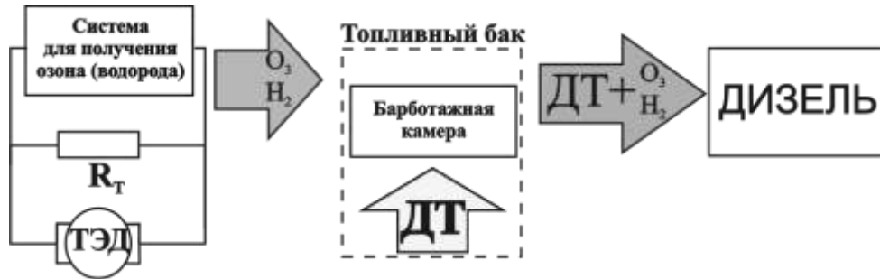
Рис. 5. Схема использования энергии электродинамического торможения для улучшения топливной экономичности дизеля
